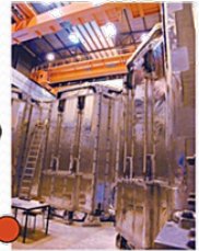
Två bilder av änd-toroidens kryogeniska kär, dels från utsidan, dels från insidan. Utan lock.
